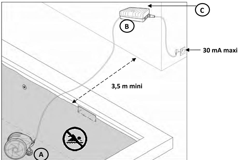
**i** Die Steuerbox kann auf dem Boden, in mindestens 3,5 Meter Entfernung vom Schwimmbeckenrand angeordnet werden.
